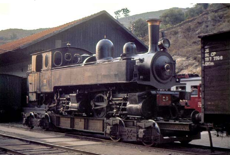
Locomotora E168 en la estación de Tua sobre un vagón destinado al transporte de material de vía estrecha por vías de ancho ibérico (foto Esten Larsen, 1977).
