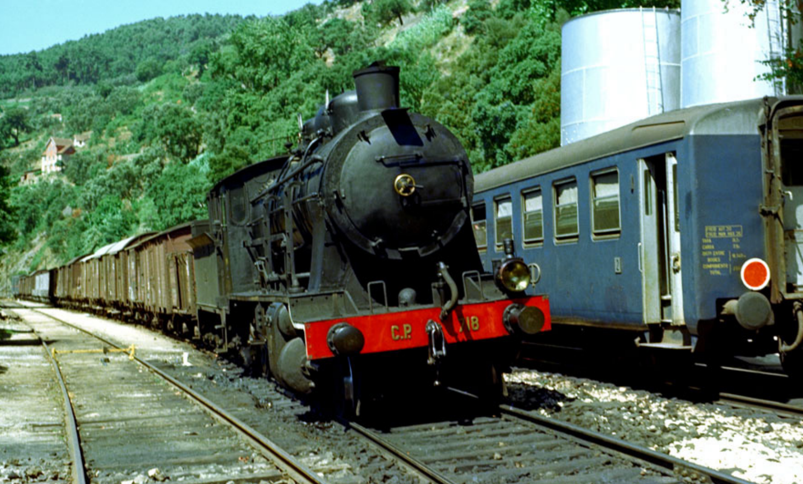
Imagen superior: Locomotora CP 718, Tipo 1-4-0 "Consolidación". Foto Werner Hardmeier
