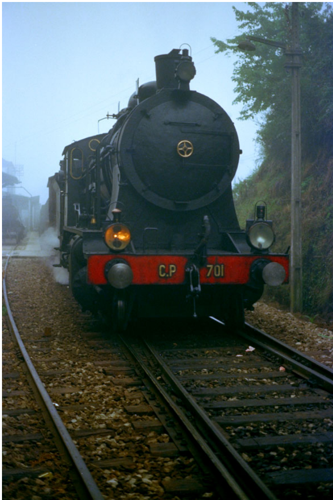
Imagen superior: Locomotora vapor CP serie 701 tipo 1-4-0 fabricada por L. Schwartzkopf, traccionando un mercante a la salida de la estación de Livração. Foto Werner Hardmeier.
